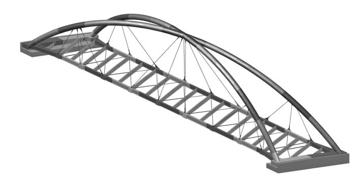
mètres de large. Il a un plan dyssimétrique avec un angle d'inclinaison des côtés d'environ 50 degrés et est suspendu aux arcs par dix-huit haubans.
